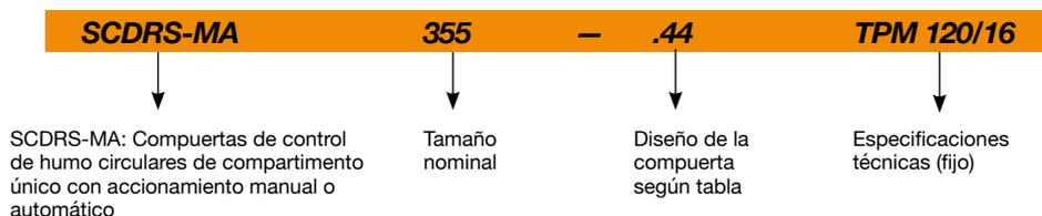
**Diseño de la compuerta**
