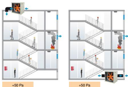
System mit Prüfzertifizierung gemäß den Anforderungen der europäischen Norm EN 12101-6:2022 und zusätzlichen Prüfungen für elektromagnetische Verträglichkeit, Umweltbeständigkeit und IP-Schutzart.
