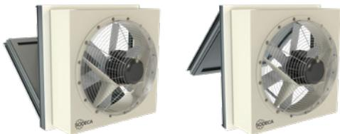
Dynamische Wandabzugsventilatoren mit motorbetriebener Öffnung, mit Schutzgitter zur Verwendung ohne Abzugsleitung. Speziell ausgelegt auf die schnelle und effiziente Evakuierung von Rauch und schädlichen Gasen im Brandfall. Geeignet zur Montage in Industriegebäuden, gewerblichen Gebäuden oder in sonstigen Gebäuden. Als Umgebungslüftung einsetzbar.
