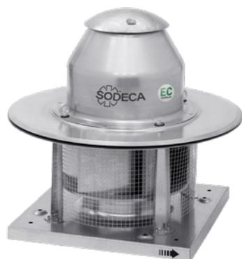
Radial-Dachventilatoren mit horizontalem Luftauslass und Schutzhaube aus Aluminium mit EC Technologie IE5 Motor und externer Elektronik.
