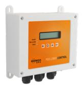
Schalttafel und selbständige automatische Steuerung für Lobbydruckbelüftungsanlagen nach EN 12101-6, kompatibel mit den Systemen KIT BOXPDS und KIT BOXPDS SMART. Sie funktionieren als Fern-Drucksensor mit automatischer Klappensteuerung, um im Brandfall den Überdruck in der Lobby aufrecht zu erhalten.
