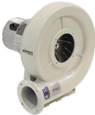
Ventilateurs centrifuges moyenne pression simple ouïe, avec la virole et turbine en fonte d'aluminium. Avec moteur EC Technology IE5 et électronique intégrée, spécialement conçus pour obtenir un haut rendement.
