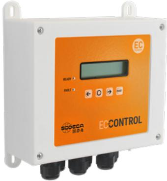
Panneau de commande pour systèmes de ventilation avec moteurs EC Technology dont l'électronique est intégrée au moteur. Le système EC CONTROL intègre toutes les fonctions nécessaires à la régulation automatique du système de ventilation mécanique contrôlée VMC, en ajustant les paramètres de vitesse du ventilateur en fonction de la qualité de l'air souhaitée et des paramètres de renouvellement.
