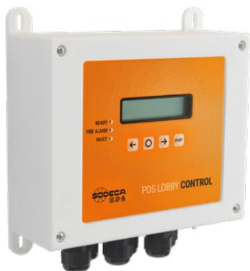
Tableau de contrôle et de réglage automatique indépendant pour systèmes de pressurisation de vestibules selon norme EN 12101-6, compatible avec les systèmes KIT BOXPDS et KIT BOXPDS SMART, agissant comme un capteur de pression à distance, avec contrôle automatique de clapets pour maintenir la surpression dans les vestibules en cas d'incendie.
