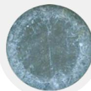
Dopo 1440 ore di prova di nebbia salina su uno strato Magnelis® non si osserva alcuna traccia di ossido rosso, mentre lo strato galvanizzato risulta completamente corroso.
