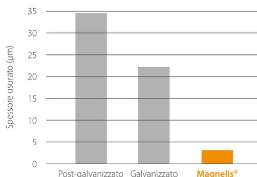
Risultati di una prova di corrosione ciclica 3CT (VDA 621-415). Fonte: ArcelorMittal Global R&D.
