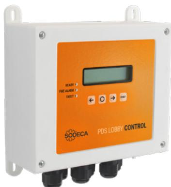
Quadro de controlo e regulação automática independente para sistemas de pressurização de átrios de acordo com a norma EN 12101-6, compatível com os sistemas KIT BOXPDS e KIT BOXPDS SMART atuando como sensor de pressão remoto, e com controlo automático de registos para manter a sobrepressão nos átrios em caso de incêndio.
