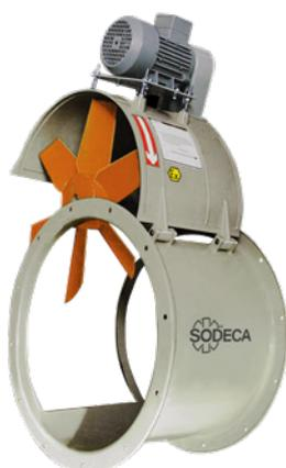
Extracteurs hélicoïdaux tubulaires entraînés par transmission, avec boîtier s'ouvrant jusqu'à 180° pour faciliter l'entretien et le nettoyage. Certificat ATEX 2G ou 2D avec moteur antidéflagrant Ex db, sécurité accrue Ex eb ou protection par virole Ex tb, pour travailler en atmosphères explosives de gaz ou de poussières. Ils peuvent également être fournis avec un moteur sans catégorie ATEX pour les ventilateurs de catégorie ATEX 3 uniquement à l'intérieur du ventilateur.
