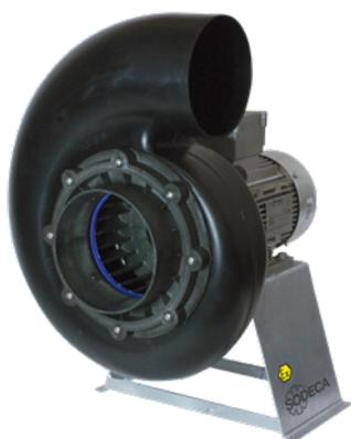
Extracteurs centrifuges de simple aspiration en matériel plastique antiestatique ATEX. Certification ATEX 2G ou 2D avec moteur antidéflagrant Ex db, sécurité accrue Ex eb ou protection par virole Ex tb, pour travailler en atmosphères explosives de gaz ou de poussières.
