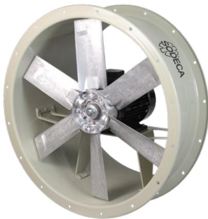
Ventilateurs hélicoïdes tubulaires avec virole courte conçus pour fonctionner dans des zones à risque d'incendie et moteur IE5 F400 à très haut rendement.
