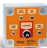
O CM-SMART indica o estado do sistema e da opção aos bombeiros de ativar ou parar o sistema manualmente através do seu seletor. Recomenda-se instalar este quadro no acesso principal da zona protegida pelo sistema de pressurização. Este equipamento não está incluído no KIT BOXPRES PLUS. Os modelos BOXPRES PLUS e BOXPRES PLUS II são compatíveis com CM-SMART.
