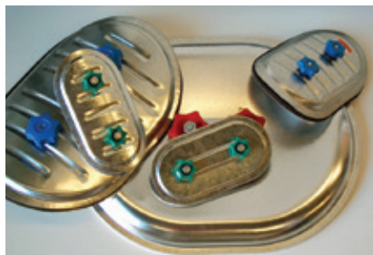
Em cozinhas profissionais proceder segundo NP EN 1037-4 Portas de visita em aço Inox instaladas cada 3m e nas mudanças de direcção superiores a 30°, bem como junto de registos de regulação, registos corta-fogo, permutadores, etc.
