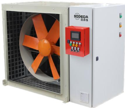
Equipos de presurización de vías de evacuación en caso de incendio diseñados según la norma europea EN 12101-6. El KIT BOXPDS SMART regula de forma automática el flujo de aire y es capaz de mantener los 50 Pa de sobrepresión aún con presencia de fugas en la instalación. El sistema es capaz de mantener la sobrepresión (Pressure criteria) y alcanzar el 90% del caudal requerido dentro de los 3 segundos siguientes a la apertura o cierre de una puerta (Airflow criteria).
