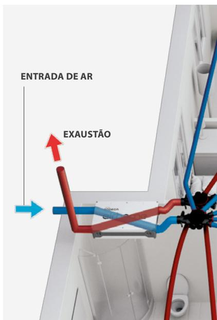
O permutador de calor é o componente do recuperador que transfere calor do circuito de exaustão de ar viciado do local, para o circuito de fornecimento de ar limpo exterior. Quanto maior eficiência térmica do permutador de calor, menor necessidade de fornecimento adicional de climatização.
